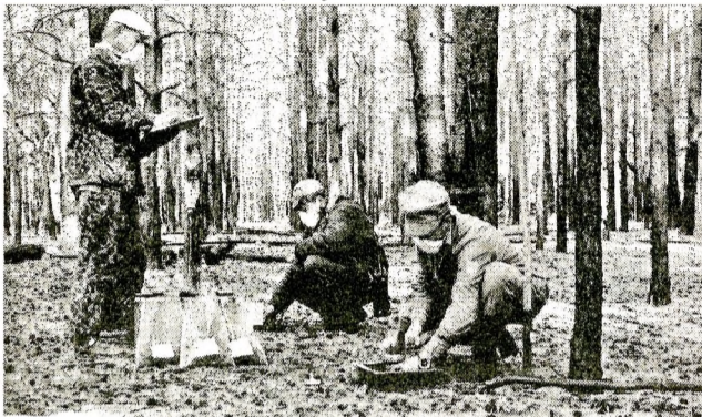
Фіксація рівнів радіоактивного забруднення і пробовідбір ґрунтових зразків для лабораторного аналізу.
