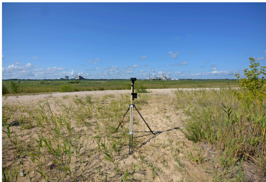
Встановлений GPS-ресивер на «дні» водойми-охолоджувача. Пристрій використовується для точності польотів дрона. На задньому плані — блоки 5-6 та головний корпус.
