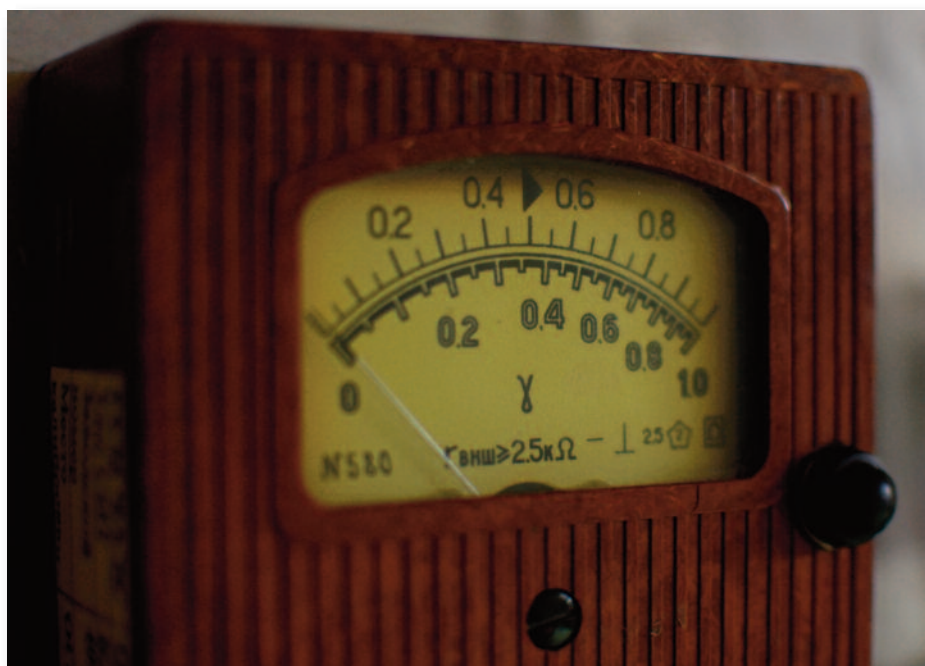
Шкала приладу КІД. Прилад може виміряти потужність до 1000 Рентгенів.
